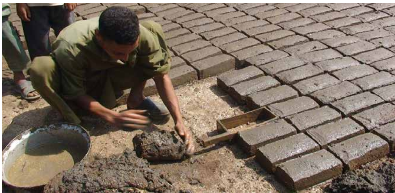
الطّوّاب أثناء صب الطين داخل القالب الخشب- الأرشيف المصري للحياة والمأثورات الشعبية
